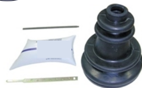
148-016 Kit Coifa Semi Eixo Lado Câmbio C/Graxa Corcel/ Del Rey/ Belina/ Pampa
