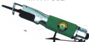
102-065-880 Serra Tico - Tico Especificações: Capacidade da chapa: 1,6 a 2,0 mm Golpes por minuto : 10.000 Consumo de ar: 5 pcm Peso: 0,9 Kg Comprimento: 215 mm Pressão de trabalho: 90 lb Mangueira:3/8
