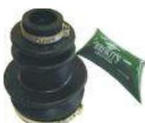
148-062 Kit Coifa Semi Eixo Lado Câmbio C/Graxa MB 180 D
