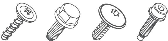
Dispositivos que garantem uma fixação de alta durabilidade. Eles se diferenciam pela forma da rosca, da cabeça, da haste e do tipo de acionamento.
