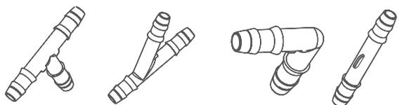
Disponíveis em quatro formatos diferentes, oferecendo versatilidade para conectar microtubos de gotejamento a mangueiras de borracha EPDM. Essas conexões são projetadas para proporcionar uma vedação confiável e durável, garantindo um fluxo consistente de água.
