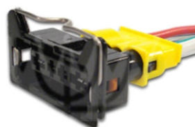
106-152-773 Conector 4 Vias Para Injeção E Vão Do Motor 2 Terminais 6,3mm e 2 Terminais 2,6mm
