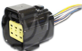
106-152-796 Conector Para Módulo De Injeção Distr. Vácuo Monza Ipanema Corsa
